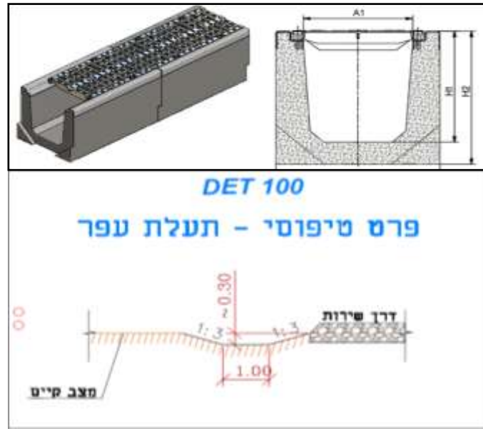
תרשים 3.1: תעלה טרומית (מגנודריין), וחתך תעלת עפר
